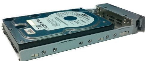
図 12: ドライブキャリアに取り付けられた SAS ディスクドライブ
