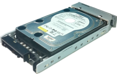
圖 13：以 Blackjack 轉接器安裝在硬碟托架中的 SATA 硬碟
