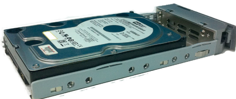
Figura 12: Unità disco SAS montata in un supporto unità
