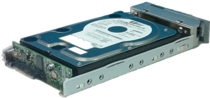
Рисунок 14: Дисковод SATA в лотке с адаптером AAMUX
