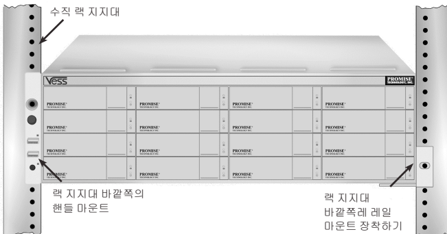
그림 10: 랙에 서버 시스템 설치
