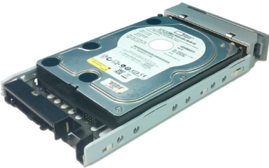
Ilustración 13: Disco duro SATA instalado en un portauidades con un adaptador Blackjack
