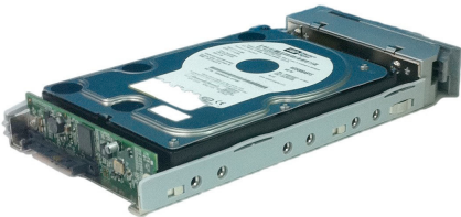
圖 14：以 AAMUX 轉接器安裝在硬碟托架中的 SATA 硬碟
