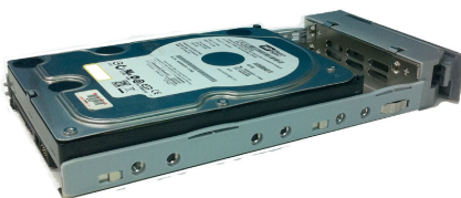
Abbildung 12: Auf einem Laufwerksträger befestigtes SAS Festplattenlaufwerk
