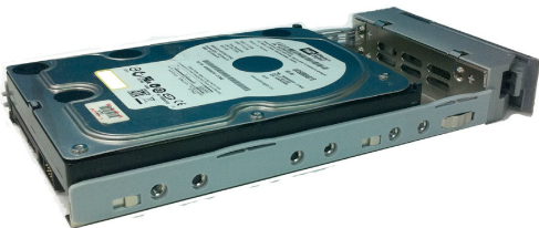
그림 12: 드라이브 캐리어에 장착된 SAS 디스크 드라이브
