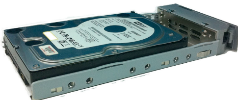
Figure 12 : disque SAS monté dans son charriot
