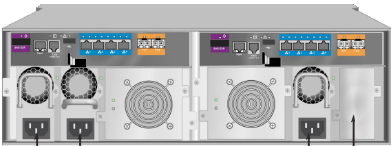
Ilustración 19: Conexiones eléctricas del panel posterior del Vess R2600fiD
