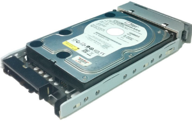
그림 13: Blackjack 어댑터를 통하여 캐리어에 장착된 SATA 디스크 드라이브
