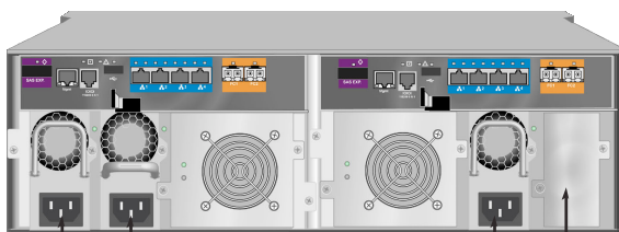
図 19: Vess R2600fiD 背面パネルの電源接続
