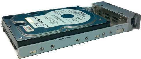
Ilustración 12: Disco duro SAS instalado en un portaunidades
