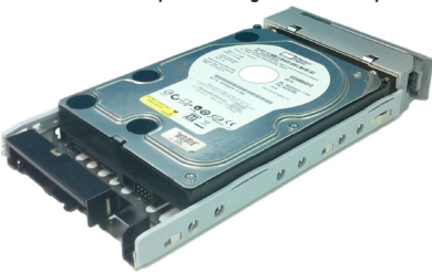
Abbildung 13: Auf einem Laufwerksträger mit Blackjack Adapter befestigtes SATA Festplattenlaufwerk
