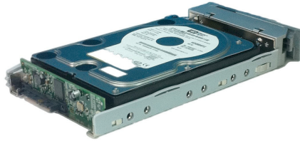
Figura 14: Unità disco SATA montata sul supporto con adattatore AAMUX
