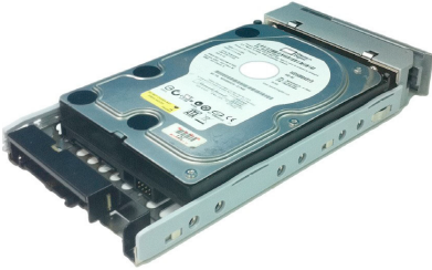
Figura 13: Unità disco SATA montata sul supporto con adattatore Blackjack
