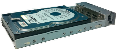
图 12：安装于硬盘托架上的 SAS 硬盘
