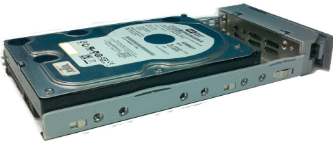
圖 12：安裝在硬碟托架中的 SAS 硬碟
