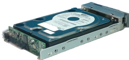
図 14: AAMUX アダプタでキャリアに取り付けられた SATA ディスクドライブ
