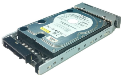
図 13: Blackjack アダプタでキャリアに取り付けられた SATA ディスクドライブ
