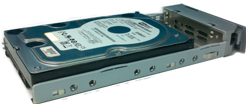
Рисунок 12: Диск SAS установленный в лотке дискодов
